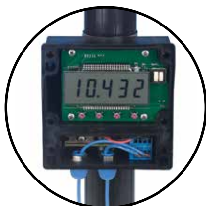
カバーを外したフロント面
